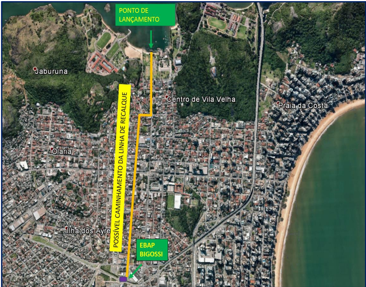
FIGURA 13 – POSSÍVEL CAMINHAMENTO DA LINHA DE RECALQUE EBAP BIGOSSE E PONTO DE LANÇAMENTO
