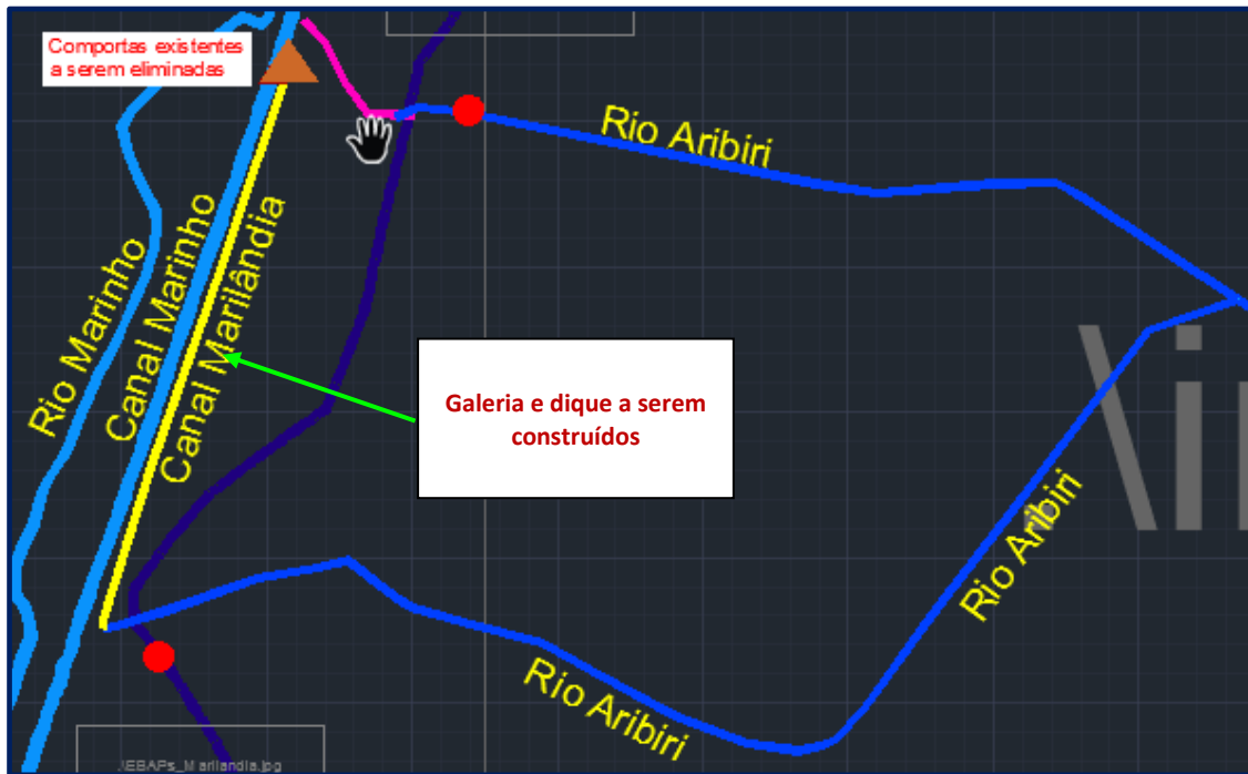
Figura 19 – Galeria e dique Canal Marilândia
