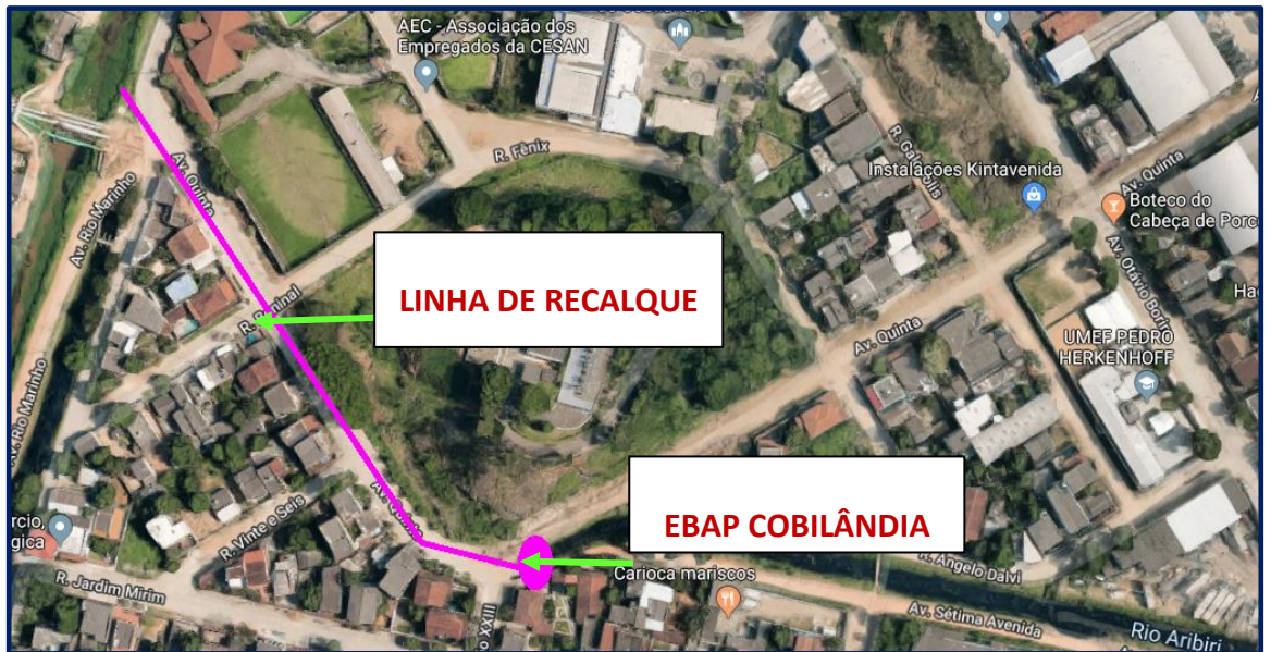
Figura 08 – Linha de recalque da EBAP Cobilândia
